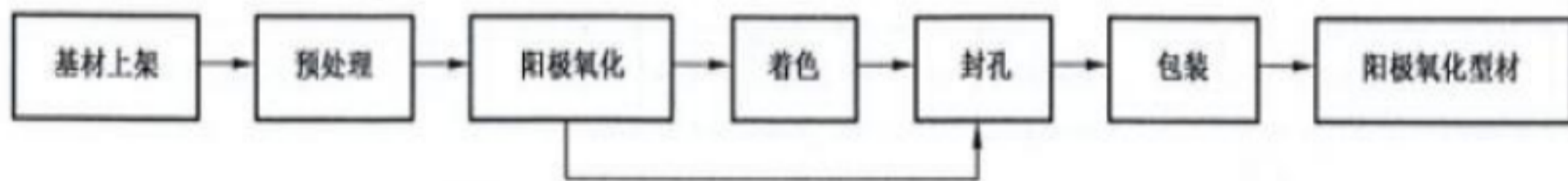
图 3.1-3 铝型材阳极氧化工艺流程图
