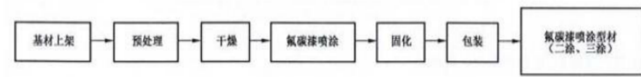
图 3.1-6 铝型材氟碳喷涂工艺流程图
