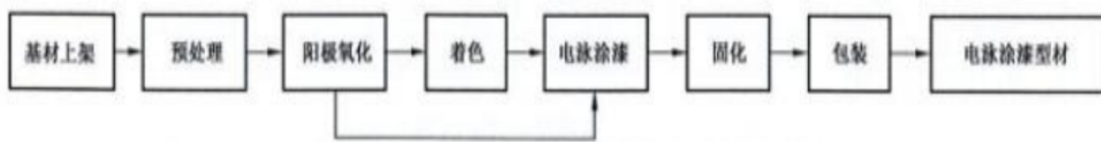
图 3.1-4 铝型材电泳涂漆工艺流程图
